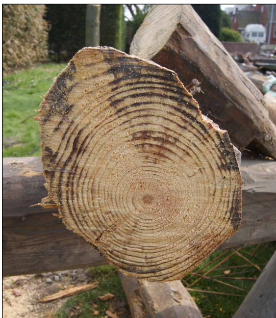
Afb. 17 De kopse kant van een van de elementen van het vierkant. Het jaarringpatroon is zeer grof, wat betekent dat de boom snel is gegroeid.
